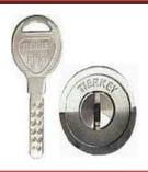
もぎ取りに強い焼入れ加工の外筒を使い、外部からの攻撃と耐久性を飛躍的に あげ鍵穴正面に特殊銅を使いドリリング対策も万全な高性能防犯シリンダーで す。
